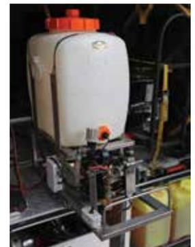
Auf einem ausziehbaren Gestell aufgebaute Sprühanlage zur Strassenreinigung
