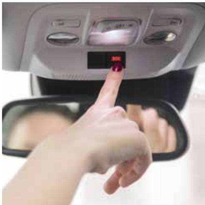
Le standard « eCall », lancé sur initiative de la Commission européenne vise à équiper tous les véhicules vendus dans l'Union européenne d'un système d'appel d'urgence permettant à une voiture accidentée d'émettre automatiquement un appel d'urgence et d'envoyer sa position précise et ce où quelle se trouve dans l'Union Européenne.
