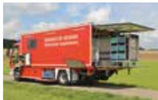
ausfahren während die geöffnete Heckklappe bei Regen zusätzlichen Schutz bietet. Die Heckklappe kann ebenfalls je nach Wunsch geschlossen bleiben und der Beladungs- bzw. Aufenthaltsraum lässt sich über eine Alu-Leiter und einer in der Heckklappe eingebauten Tür betreten.
