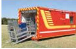
Im Geräteraum am Heck ist eine Klimaanlage gelagert welche bei hohen Temperaturen im Behandlungsraum mit wenigen Handgriffen eingehängt werden kann und die notwendige Abkühlung liefert. Die im Abrollbehälter vorhandenen Batterien ermöglichen autonome Stromzufuhr für eine Stunde. Danach muss Stromzufuhr von externer Quelle erfolgen. Im Behandlungsraum sind links und rechts 2 Fenster mit Rolläden eingebaut um bei Tag genügend Licht im Innern des Behandlungsraumes vorzufinden.
