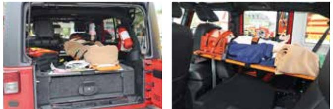
Fahrzeugfunk, Handfunkgerät mit fester Ladestation, Signalanlage Hella, Frontblitzer, Navigationsgerät, Feuerwehrraltdreieck, 6 kg Pulverlöcher, Erste Hilfe Rucksack und Abschleppseil.
