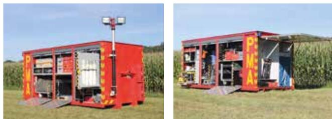
Dieser Abrollbehälter wird durch ein Wechselladerfahrzeug des CISETT zur Einsatzstelle gefahren.
