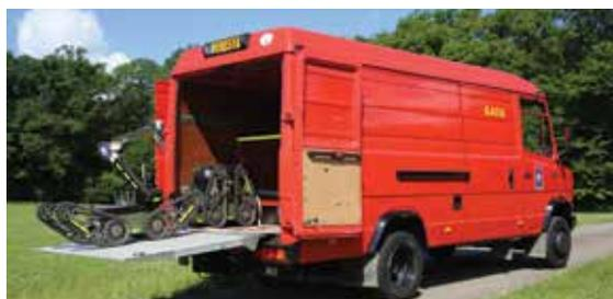
In der Ladung enthalten: 2x Robo (Roboter) der Marke TELEROB Typ TELEMAT mit diversem Zubehör.
