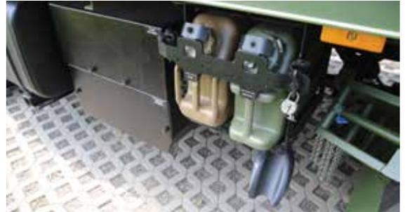
In einer Halterung: 2 Plastikkanister von 20 Liter davon einer für Wasser und einer für Dieselkraftstoff
