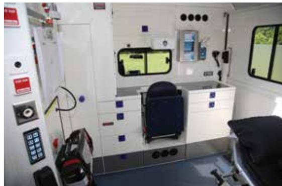
An der Wand zwischen Fahrer und Krankenraum befinden sich 5 Schubläden sowie 2 Schränke, davon einer ausziehbar zur Unterbringung des notwendigen Materials sowie ein fest montierter Klappsitz.
