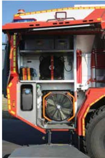
2 Belüftungsgeräte befinden sich in G6
