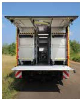
Weiterhin kann die Heckklappe mit Tür komplett geöffnet werden und nach oben aufgeklappt werden. Von unten kann eine doppelt klappbare unterfahrbare Ladeborwand ausgefahren werden (z.B. bei Entnahme der Rollcontainer)
