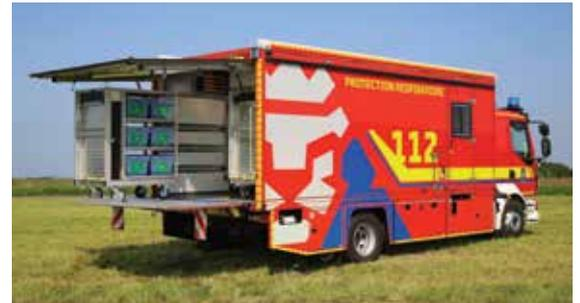
Im Laderaum selbst können bis zu 9 Rollcontainer aufgeladen werden. Das Fahrzeug wurde mit 7 Rollcontainern ausgeliefert ( 6 für Atemschutzgeräte, 1 für Reserveflaschen)
