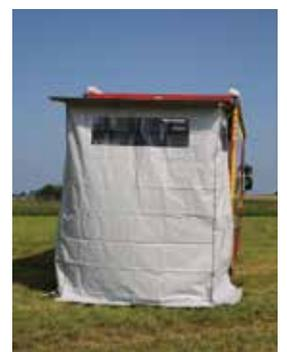
Beidseitig des Kastenaufbaus an den Seitenwänden sind ausfahrbare Markisen von Thule Modell 6 mit Abstützung und einhängbarem Vorzelt befestigt.
