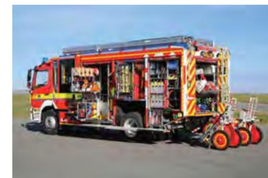
Bei diesem Löschfahrzeug ist der Kühlergrill rot lackiert. An der Dachkabine ist ein Bodenradar montiert (weisser Kasten mit Spitze) . Durch dieses Gerät kann die Flugleitstelle (Tower) jederzeit orten wo sich das Löschfahrzeug im Flughafenbereich befindet.
