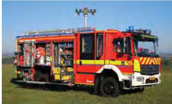
Ein ab Boden 6m elektro-pneumatisch ausfahrbarer Lichtmast mit 6 LED Strahlern befindet sich in der Mitte des Fahrzeugs hinter der Mannschaftskabine
