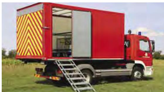
Über die klappbare Hecktür kann nach Absetzen des Containers die bequeme Ladung der Rollwagen vorgenommen werden.
