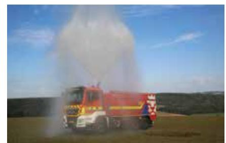
Steht der Wasserwerfer senkrecht nach oben in maximal geöffneter Sprühstrahlposition kann zum Selbstschutz des Fahrzeugs ein Wasserschutzschild gebildet werden.
