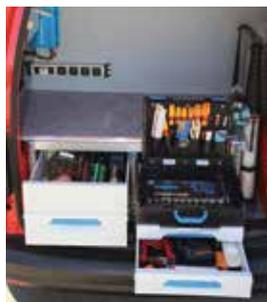
Sortimo Inneneinrichtung (Schrank mit Schubläden) sowie Arbeitsplattform
