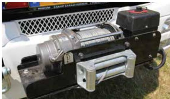
Seilwinde Warn Modell CE M12000 mit maximaler Zugkraft von 5 400 kg und 9 mm Stahlseil
