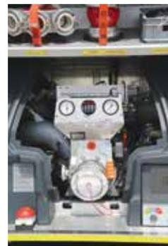
FPN 10 - 2000 (Nennförderdruck 10 bar bei Nennförderstrom 2000 l/min)
