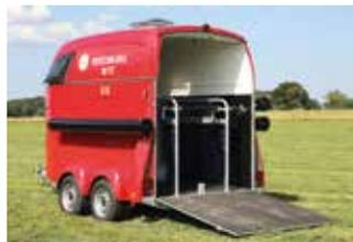
Verletzte, liegende Tiere können mit einer Seilwinde sowie daran befestigter Bergungsplane oder Netz in den Anhänger gezogen werden. Die Plane oder das Netz wird zuerst unter dem Tier durchgezogen. Tiere welche nicht aus eigener Kraft im Anhänger stehen können werden ebenfalls über diese Seilwinde gehoben und in einer speziellen Hängevorrichtung abtransportiert.
