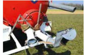
2) Als Wasserreserve für Löschfahrzeuge . Dabei werden links und rechts die angeschweissten Schieber über den Wasserrwannen geöffnet sodaß das Löschwasser aus dem Tank in die Wannen fließen kann. Über die am unteren Teil der Wasserrwannen befestigten A- Kupplungen können die Löschfahrzeuge mittels Saugschläuche ihre leeren Wasserbehälter erneut füllen.
