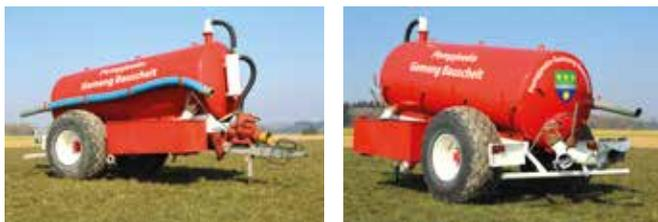
Bei einem Maschinenhändler wurde ein gebrauchtes Güllefaß erworben, von den Gemeindearbeitern komplett überholt und lackiert und zum Löschwasseranhänger umgebaut.
