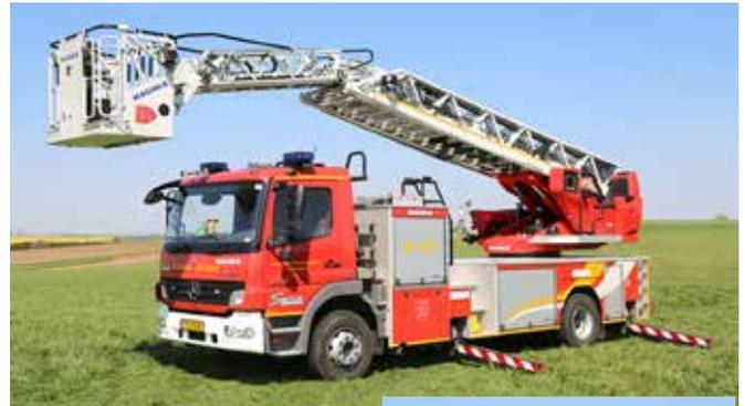
Mercedes-Benz mit Drehleiteraufbau von Magirus
