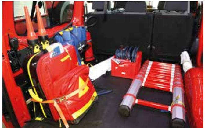
Tragetasche mit 2 l O2-Flasche samt Zubehör (Masken, Sonden usw.), 1 tragbarer LED-Scheinwerfer mit Akku Modell Ritelite K9, Werkzeugkasten, Spineboard mit Kopfhaltssystem, Pulverlöcher PG 6, Absperrband 500 m, 2 faltbare Warndreiecke, 4 Faltkegel mit LED-Beleuchtung, Teleskopleiter 4,4 m (für Feuerwehreinsätze zugelassen) Telemaster XXL.
