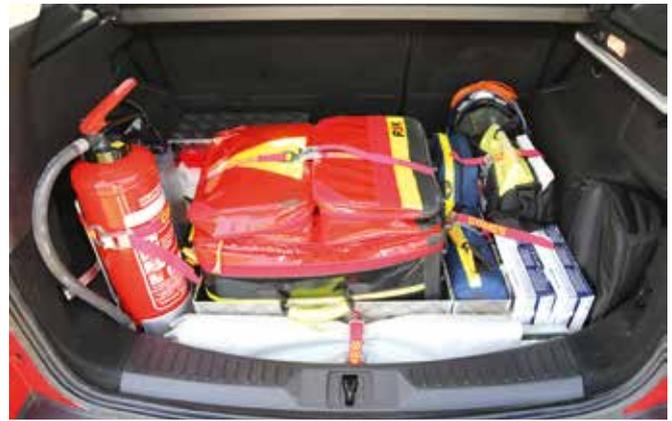
**Beladung :** Notfallrucksack, Oxybag mit 2 l O<sub>2</sub> – Flasche, AED – halbautomatischer Defibrillator von Zoll, 2 Schachteln Einmal-Handschuhe, 2 Decken, Force Rettungsgerät, Absperrband, 2 faltbare Warndreiecke, Werkzeugtasche, 6 kg Pulverlöscher, Set Halskrausen, Schutzhelm, fest eingebauter Funk, Handsprechfunkgerät, I-Phone, Stablampe Mag-Lite.
