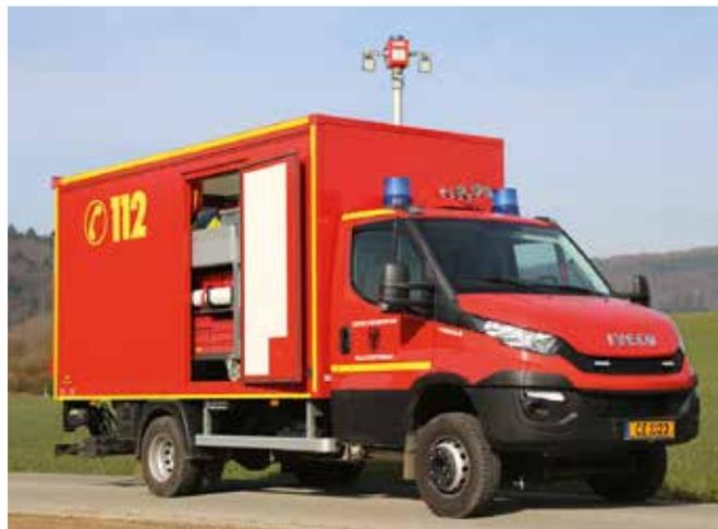
Die spezialisierte Firma Achleitner Fahrzeugbau aus Wörgl in Österreich baute das Fahrgestell auf Allrad um.
