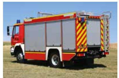
rechten Fahrzeugseite wurde sämtliches feuerwehrtechnische Material untergebracht während die Geräteräume der linken Fahrzeugseite alles zur Verfügung stehende Material für technische Hilfeleistung und Bergung aufnehmen.
