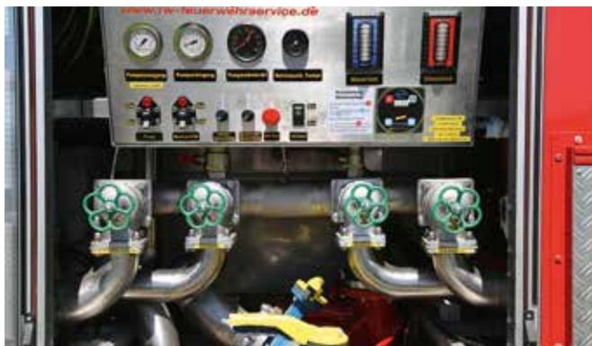
Die Verrohrung der Pumpe wurde integral erneuert. Die elektronische Steuerung der Pumpe ebenfalls. Die neue Zumischanlage für Löschschaum vom Typ Hale FoamLogix ergänzt die Überholung der Pumpeneinheit. Die finanziellen Unkosten übernahm die Gemeindeverwaltung. Vorne über der Stoßstange befinden sich 2 Kanister à 20 Liter mit Ölbindemittel. (waren bereits vorhanden vor der Überholung)
