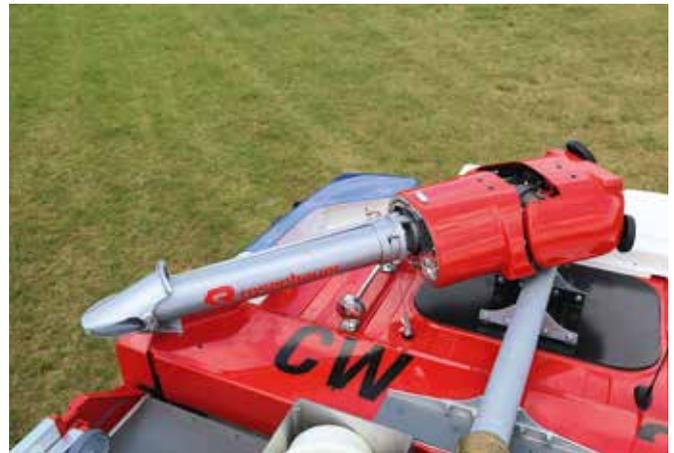
Elektro Trommel (selbstaufwickelnd) mit 30 m Stromkabel (240 / 400 V ) und Verteilerstecker
